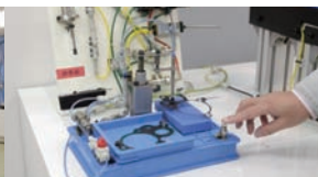
見学コース最後の体験コーナー(左上)。「時は金なり」。コマ何秒の効率向上のための工夫を、模擬システムで体験できる。写真(右上)は吹き出す空気力で薄い部品を1枚ずつ移動する仕組み。
